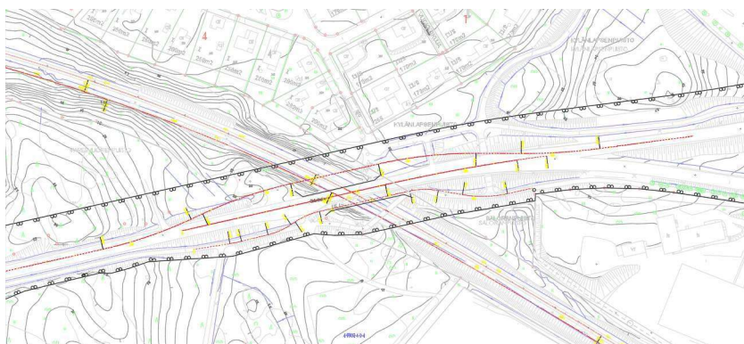
Kuva 6. Vaihtoehto 3 radan ylittävän sillan uusimiseksi.
